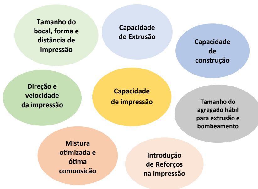
Figura 10 – Parâmetros para processos de impressão 3D (Adaptado de Al Rashid et al.)
