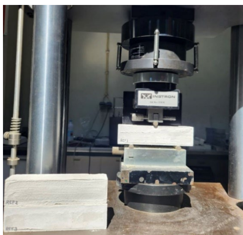
Figura 107 – Ensaio de resistência à flexão
