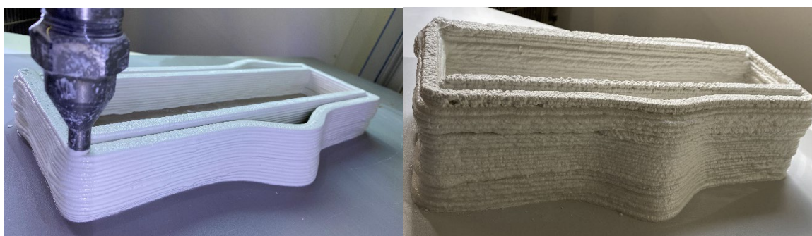
Figura 118 – Modelos impressos sem e com a adição de vidro.
