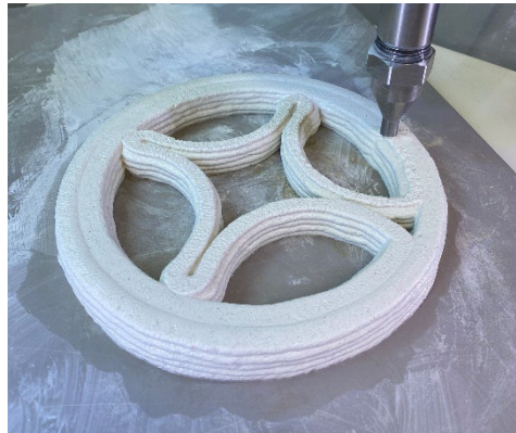
Figura 92 – Teste de impressão da amostra C10
