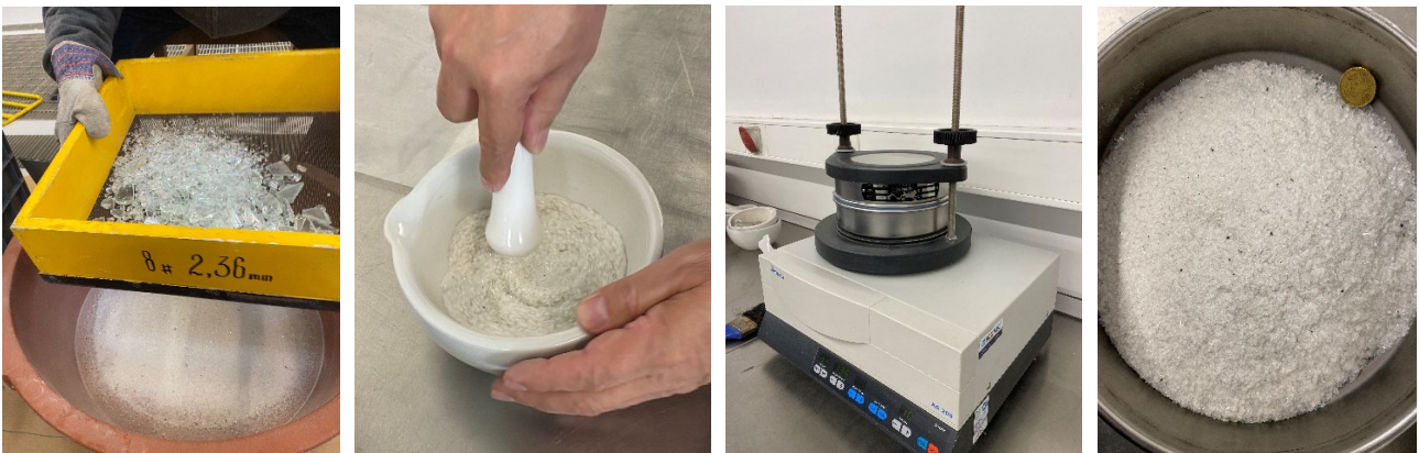
Figuras 62 a 65 – Crivagem a 2,36mm, moagem em almofariz, crivagem em agitador de peneiras, e partículas de vidro menores que 1,7mm respetivamente.
