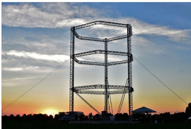
Figura 41 e 42 – BIG Delta WASP 12MT em processo de impressão e estrutura de 12 metros da impressora (WASP 2015)
