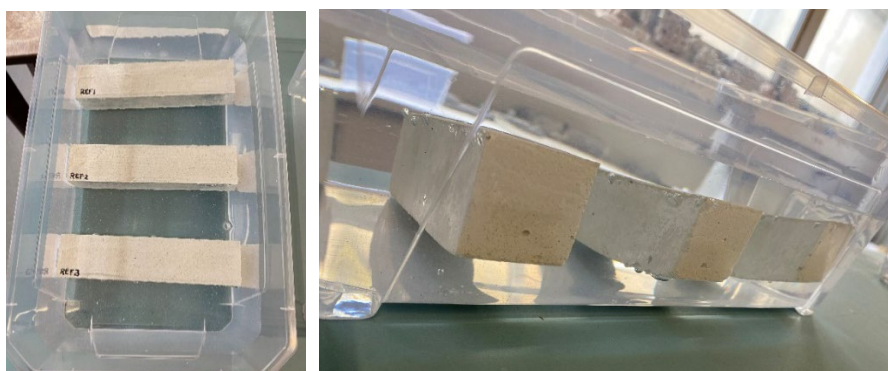
Figura 105 e 106 – Provetes em cura por imersão
