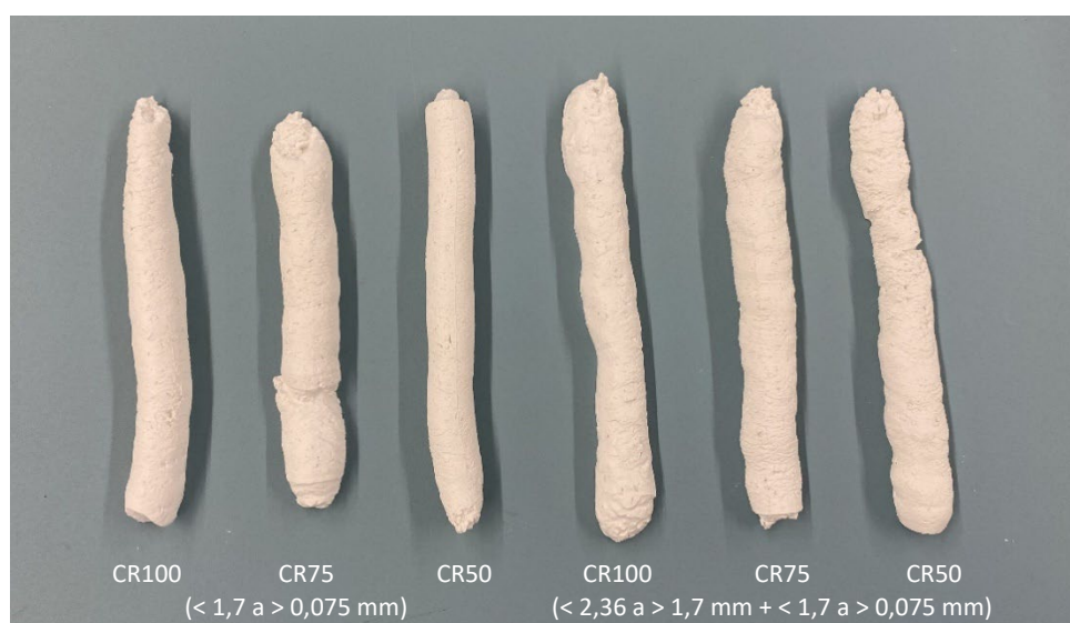
Figura 76 – Ensaio da capacidade de extrusão de amostras com resíduo de vidro
