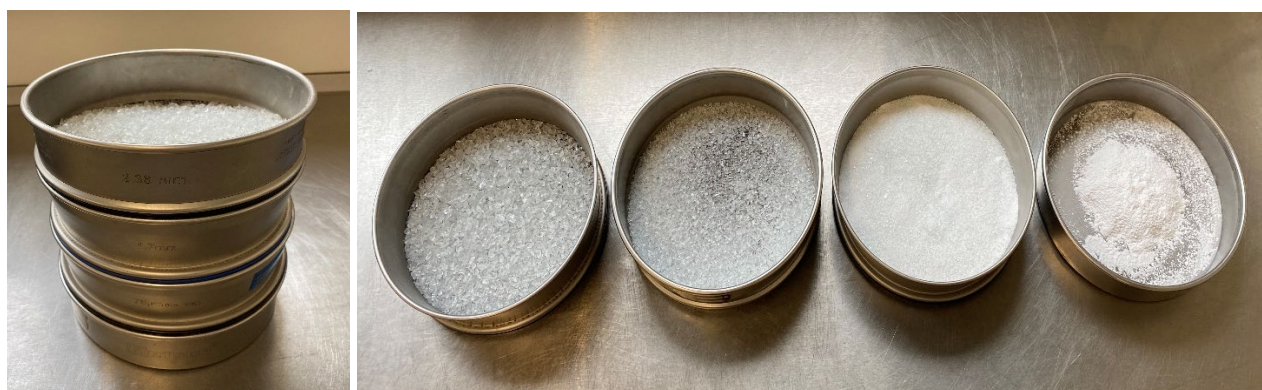
Figuras 69 e 70 – Resultantes da crivagem de variadas granulometrias
