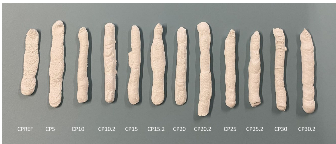
Figura 72 – Ensaio da capacidade de extrusão de amostras com pó de vidro
