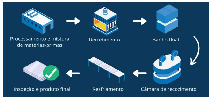
Figura 02 – Processo produtivo do vidro (adaptada de PROPEQ 2021)
