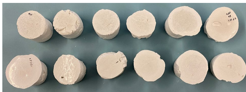
Figura 75 – Provetes dos ensaios de abaixamento das amostras com pó de vidro
