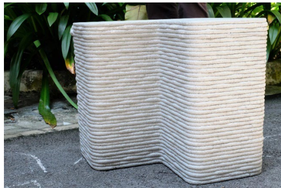
Figura 16 – Bloco impresso em 3D (NTU Singapore 2022)
