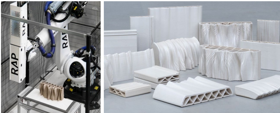
Figura 29 e 30 – Processo de impressão dos ladrilhos e diversidade de peças impressas (Studio RAP 2014)
