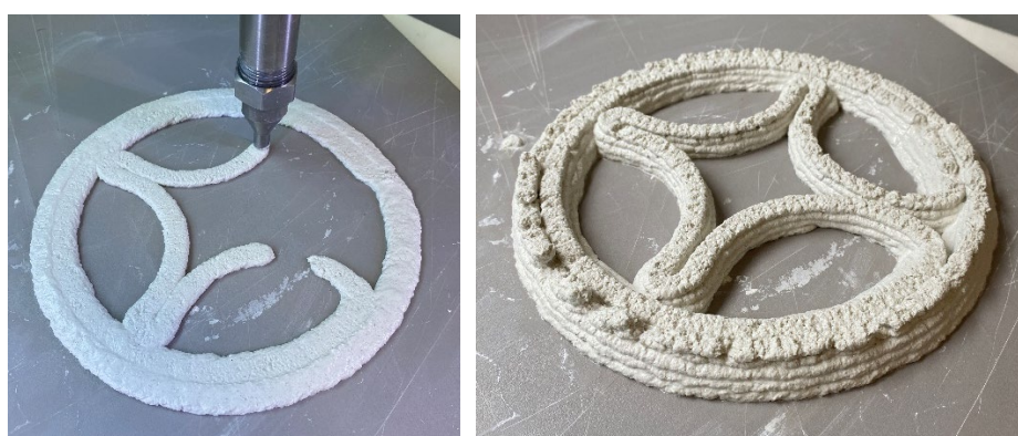
Figuras 97 e 98 – Teste de impressão da amostra CPR 80+18
