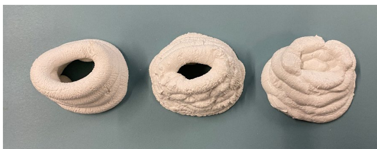
Figura 74 – Extrusão manual de amostras com diferentes teores de água
