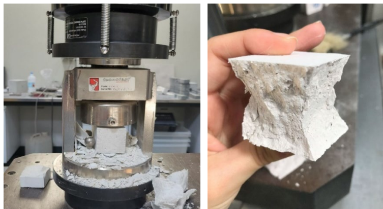
Figura 108 e 109 – Ensaio de resistência à compressão
