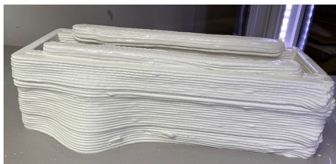
Figura 117 – Modelo impresso com acúmulo de material nos cantos
