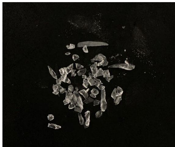
Figura 05 – Partículas de resíduo de vidro com diferentes tamanho e formas após processo de moagem e crivagem (imagem do autor)
