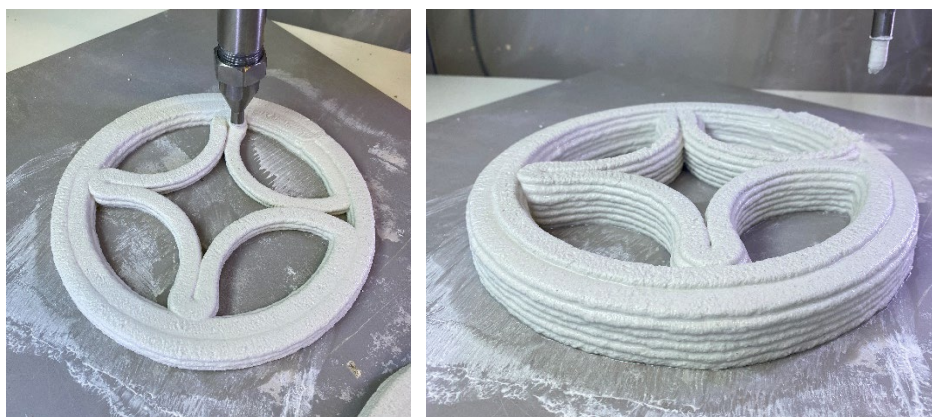
Figuras 102 e 103 – Teste de impressão da amostra CPR 100+25
