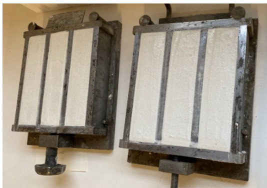
Figura 104 – Preparação dos provetes para ensaios mecânicos
