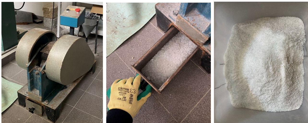
Figuras 66 a 68 – Britador de maxilas, resíduos após britagem e resultado após contínuas operações.
