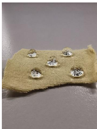
Figura 3.10 – Exemplo de um substrato têxtil funcionalizado com capacidade hidrofóbica.
