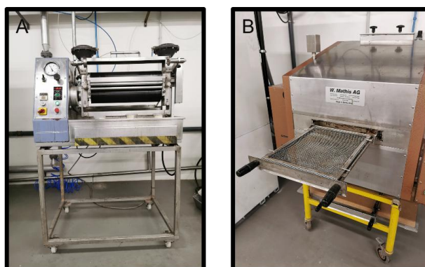
Figura 3.2 – A) Foulard Mathis HVF 27291; B) Secador Mathis DHE 51991.
