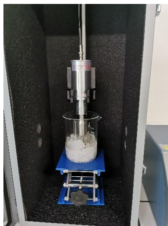
Figura 3.4 – Montagem realizada para o processo de extração por sonicação.
