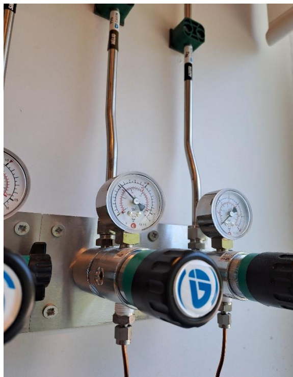
Figura 11: Redutor de caudal e manómetro para controlo da pressão do gás de arraste
