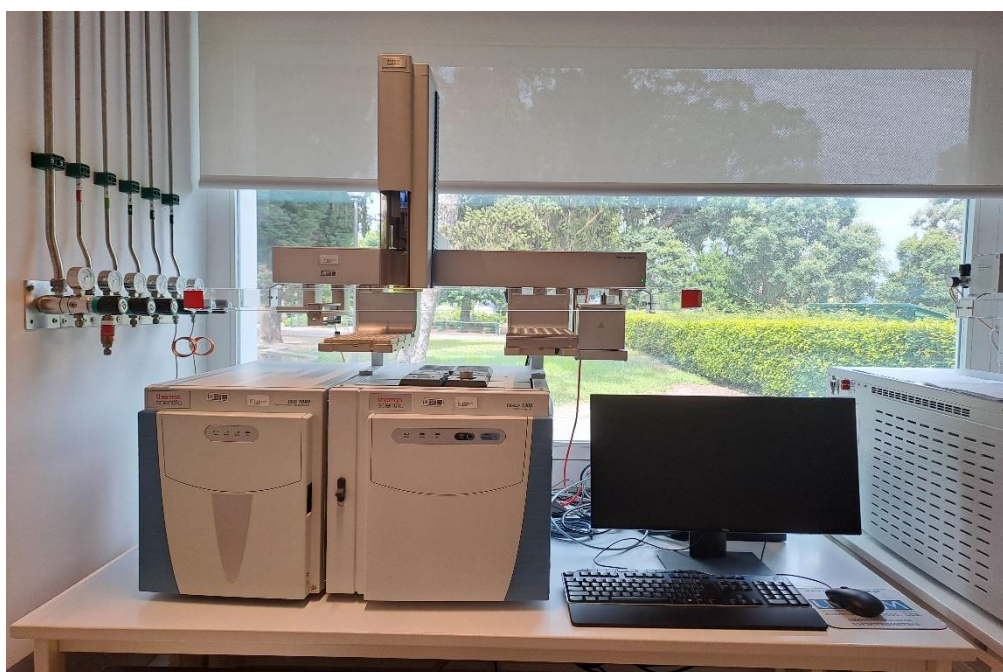
Figura 2: Instrumento de SPME-GC-MS conectado a computador
