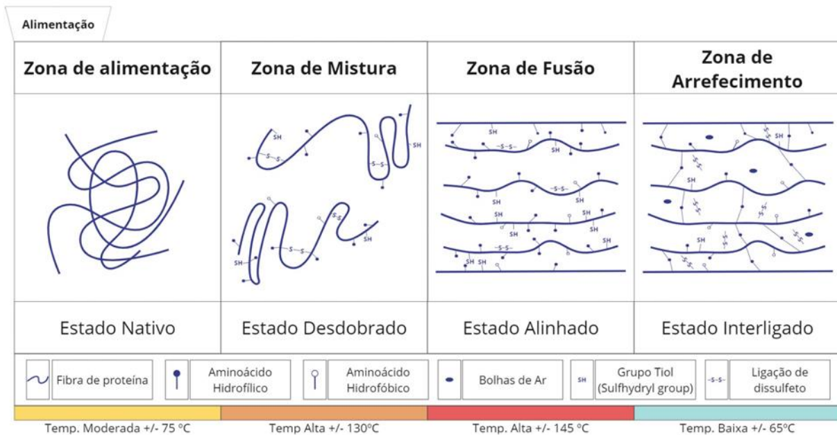
Figura 10 – Esquema do processo de texturização (Fonte: Ryu, 2020).
