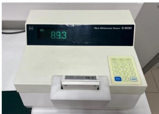
Figura 14. Kett Eletic Laboratory (colorímetro) para análise do grau de brancura
