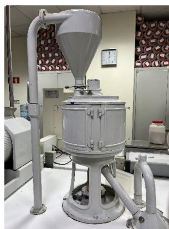
Figura 9. Branqueador de arroz utilizado em laboratório
