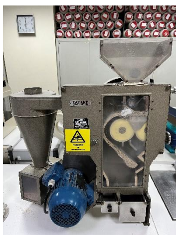
Figura 10. Descascador de arroz utilizado em laboratório
