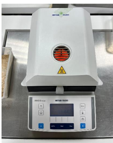
Figura 12. Termobalança HB43-S Halogen para determinação do teor de humidade
