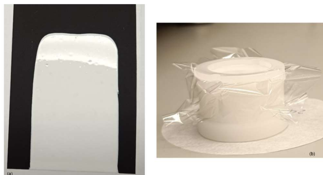
Figura 17- (a) Exemplo de uma carta de cobertura para a determinação do teor de titânio numa tinta, (b) Copo de amostra utilizado nos ensaios de XRF
