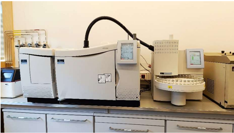
Figura 5- Cromatógrafo gasoso, Clarus 680 da Perkin Elmer, acoplado a um amostrador de Headpace, TurboMatrix 40 da Perkin Elmer e a um detetor de Espetrometria de Massa da Perkin Elmer disponível no centro de I&D da CIN.
