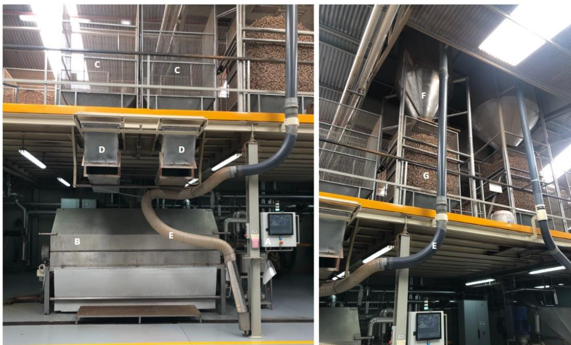
Figura 38. Máquina industrial “Vinox 2” utilizada nos ensaios industriais de otimização do tratamento de desinfecção Vapoextração e respetivos componentes. A – Consola tátil; B – Tambor fechado; C – Zona de carga; D – Mangas de carga do tambor; E – Manga de aspiração/descarga; F – Silos de descarga; G – Carros.
