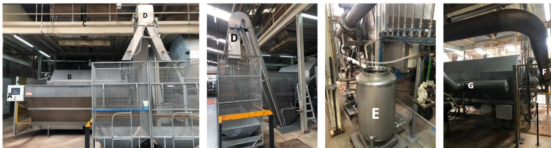
Figura 32. Diferentes componentes da máquina de lavação NLLV1. A – Consola tátil; B – Tambor fechado; C – Zona de carga; D – Girafa de descarga; E – Balança com célula de carga; F – Entrada de calor pelo veio; e G – Entrada de calor pela parte de trás da máquina.
