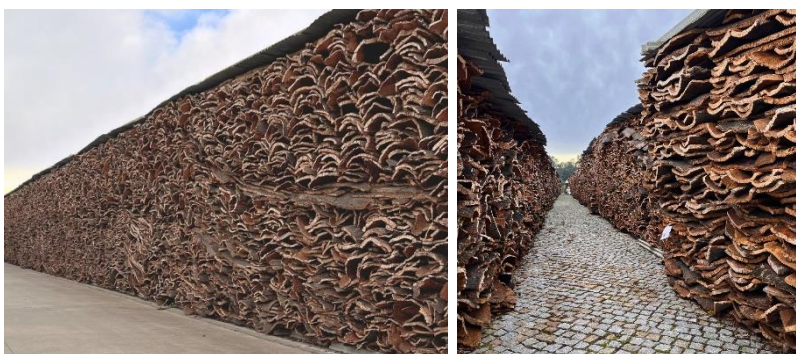
Figura 18. Estaleiro da Socori, S.A. – Pranchas de cortiça empilhadas sobre vigas e cobertas por chapas e vigas. Retirado de https://www.linkedin.com/company/socori-bourrasse/posts/?feedView=all (acesso a 17 janeiro 2024)
