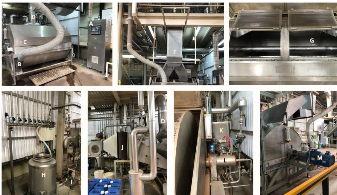
Figura 29. Diferentes componentes da máquina de lavação Vinox 3. A – Consola tátil; B – Manga de aspiração/descarga; C – Tambor fechado; D – Tubo de exaustão; E – Zona de carga; F – Mangas de carga do tambor; G - Interior do tambor; H – Balança com célula de carga; I – Bomba de diafragma; J – Permutador Trás; K – Permutador Veio; L – Entrada dos reagentes para o tambor; e M – Motor de rotação.
