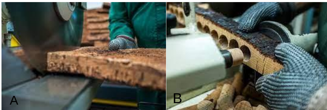
Figura 22. Processo produtivo de rolhas de cortiça natural. A – Rabaneação de pranchas de cortiça; B – Brocagem semiautomática. Retirado de https://www.apcor.pt/cortica/processo-de-transformacao/percurso-industrial/rolhas-naturais/ (acesso 17 janeiro 2024)
