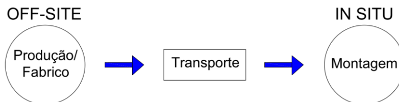
Fig. 7 - Três principais fases da construção prefabricada
