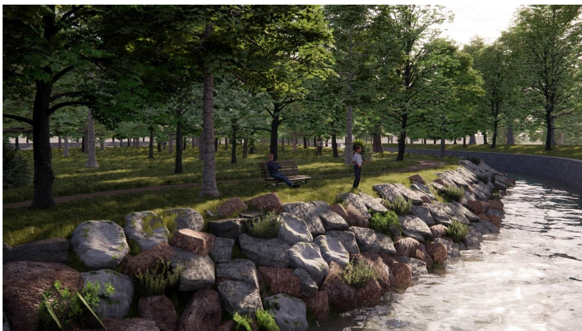
Figura 67. Enrocamento vivo com estacas vivas de Salix sp.
