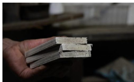
Figura 115- A liga metálica vazada para uma rilheira, depois de sólida forma um lingote de prata.
