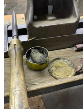
Figura 103- Na oficina do Sr. Domingos Guedes, utiliza-se sebo para lubrificar as peças.
