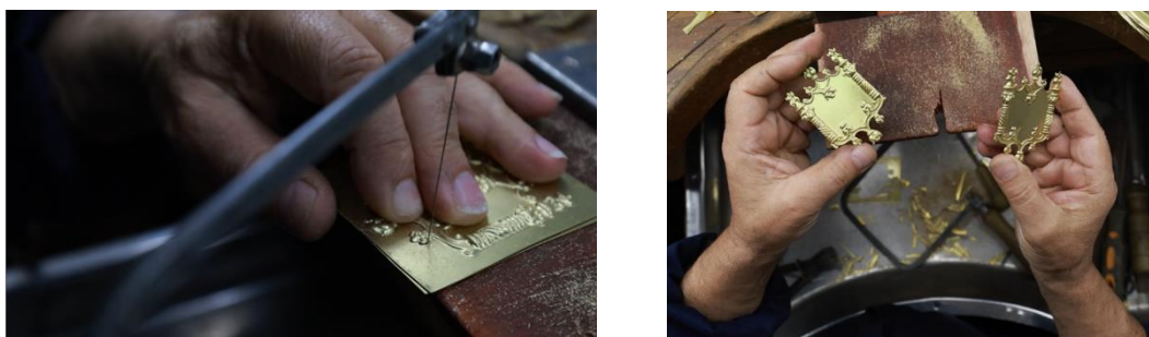
Figura 118- Remoção do excesso de metal, com o auxílio de uma serra de mão.
