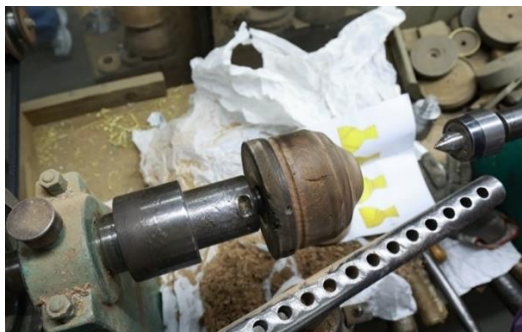
Figura 100- Criação de um molde de madeira no torno mecânico (esq.); A oficina de Domingos Guedes, em Gondomar, guarda uma vasta coleção de moldes de diferentes materiais.
