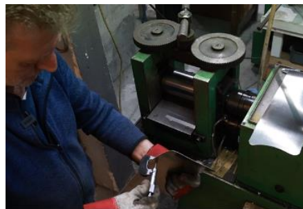
Figura 116- Processo de laminação (esq.); Medição da espessura da lâmina (dir).
