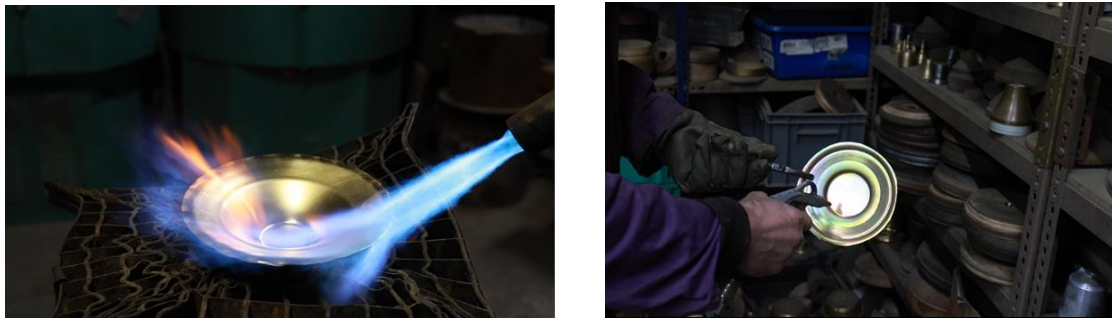
Figura 102- Aquecimento do metal até à temperatura de recozimento (esq.); Resfriamento do metal (dir.).
