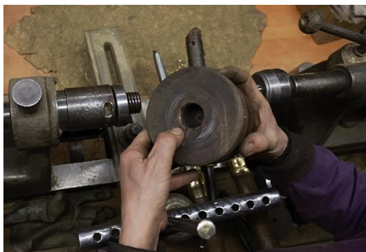
Figura 99- Molde pré-dimensionado (esq.); Disco de metal fixo no torno mecânico (dir.).
