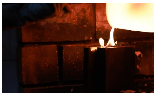
Figura 115- A liga metálica vazada para uma rilheira, depois de sólida forma um lingote de prata.
