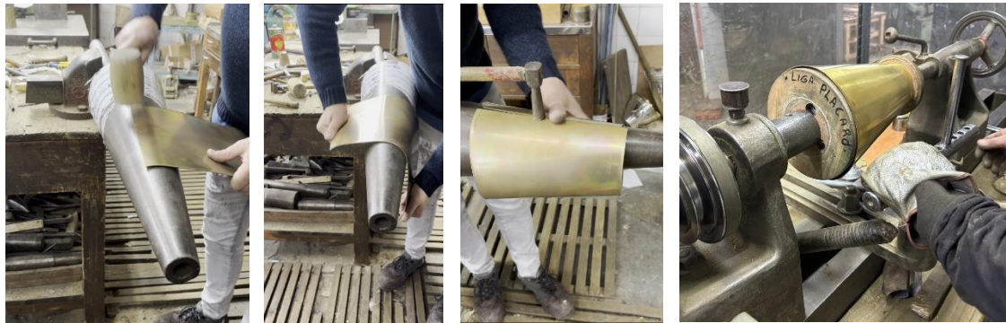
Figura 108- A chapa de metal é cuidadosamente modelada, até poder ser fixa no torno mecânico.
