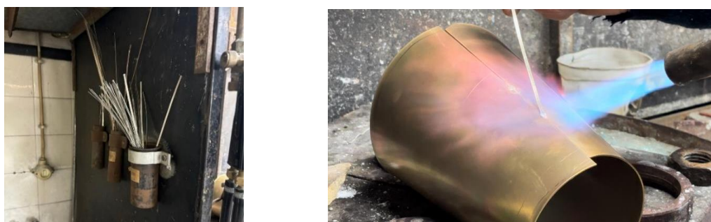
Figura 106- Fitas de solda de prata (esq.), Procedimento de soldadura (dir.).
