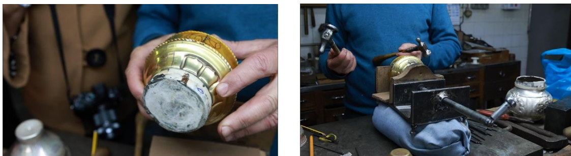
Figura 110- Interior da peça preenchida com breu (esq.); O sistema utilizado pelo cinzelador Fernando (dir.).
