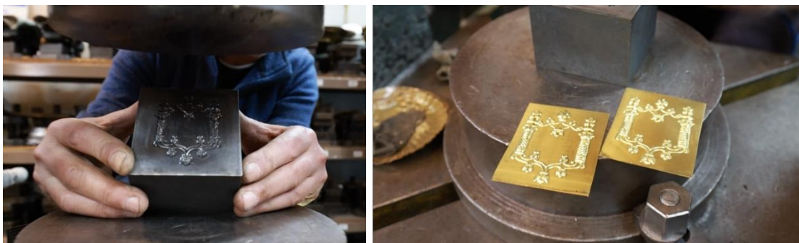
Figura 117- Matiz posicionada sob o balancé (esq.); Resultado do processo de estampagem (dir.).
