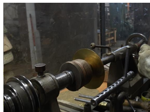
Figura 99- Molde pré-dimensionado (esq.); Disco de metal fixo no torno mecânico (dir.).
