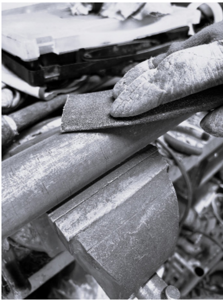
(figura 42) Processo de recuperação do cilindro. Por ter sido adquirido numa sucata, esta peça, constituída de ferro, tinha bastante ferrugem e o seu processo de recuperação passou por polir a superfície, manualmente, com uma lixa de papel.
