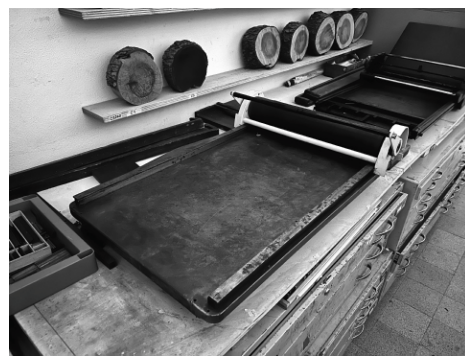
(figura 51) Prelo de provas cedido pela Tipografia Dias. Usado como ferramenta de comparação dos resultados de impressão obtidos entre um prelo de provas calibrado mecanicamente com a 59PRESS.
