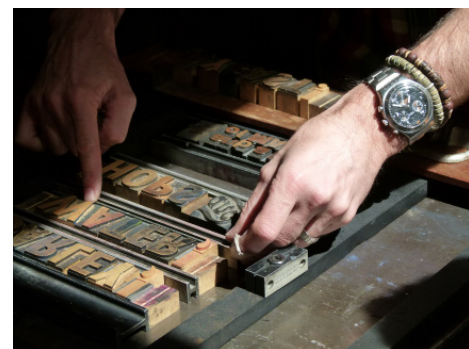
(figura 13) Composição tipográfica presa na rama pronta para impressão (esquerda); Montagem de composição tipográfica (direita)
