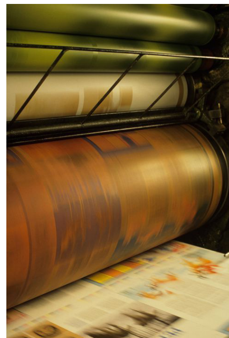
(figura 6) Técnica de offset em funcionamento. É possível perceber a transferência do grafismo da chapa para o rolo e do rolo para o papel.
