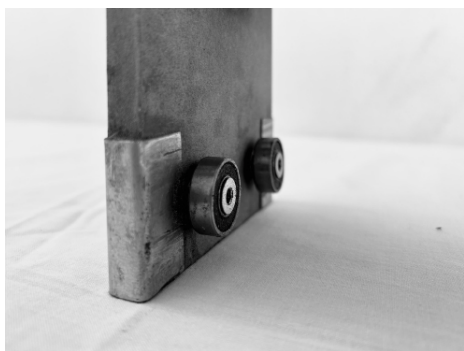
(figura 46) vista interior da cabeça de impressão em que é possível perceber a montagem dos rolamentos e aplicação das chapas nos limites das placas laterais.
