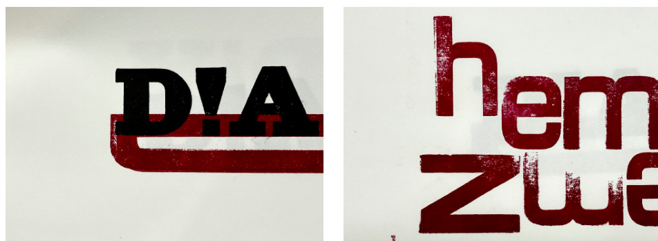
(figura 65) Provas de teste que exemplificam o erro causado pelo salto do cilindro no primeiro impacto com a matriz. É possível verificar uma ligeira “repetição” da impressão nesse primeiro contacto com o cilindro do lado esquerdo dos caracteres iniciais (à esquerda da composição)— ex. “h” na imagem da direita ou faha no “D” deitado (imagem da esquerda)
