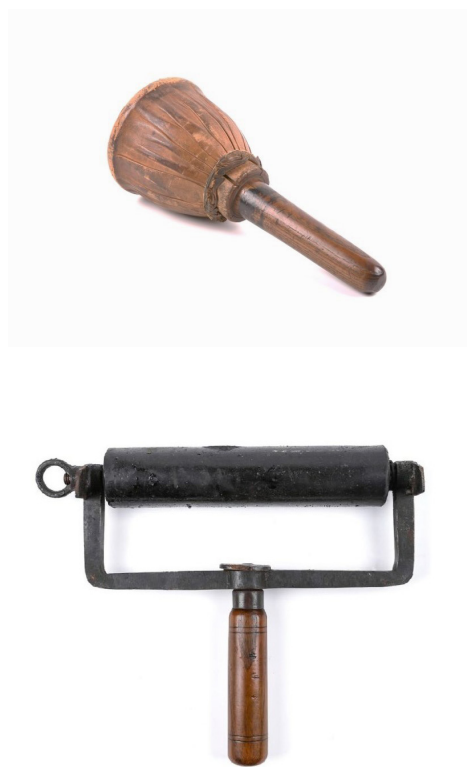
(figura 14) Bala de tintagem (em cima) usada na xilogravura até à revolução industrial, quando foram substituídas pelos rolos de tintagem (em baixo). Imagens do arquivo da Imprensa Nacional (Imprensa Nacional, 2024).
