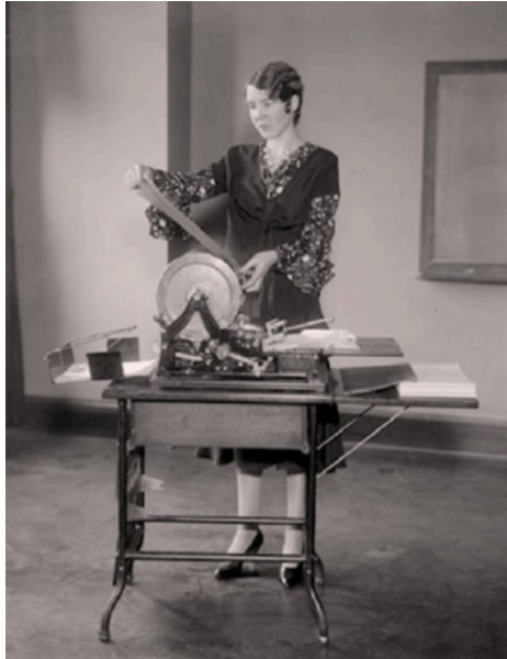
(figura 3) O mimeógrafo ou duplicador de stencil foi inventado por Thomas Alva Edison, 1876 (Alessandro Ludovico, 2012), tratava-se de uma máquina que forçava a tinta através de um stencil para um papel (Jury, 2018).
