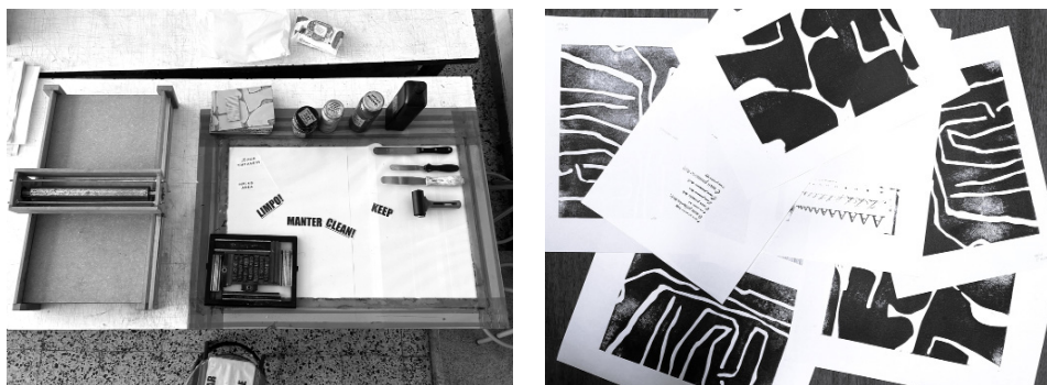
(figura 49) Momento de testagem da 59PRESS e respectivas provas (à esquerda) dos vários tipos de matrizes, desde chapas de fotopolímero, a placas de linóleo e ainda caracteres móveis.
