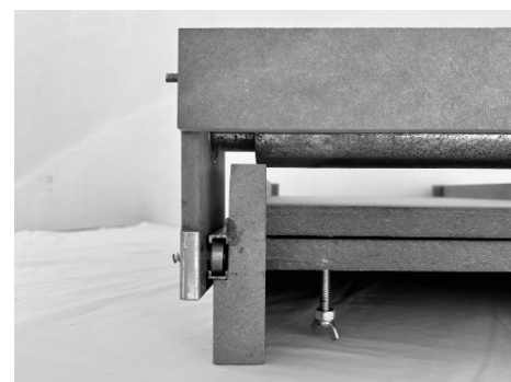
(figura 40) Detalhes do sistema de calhas utilizado na 59PRESS.
