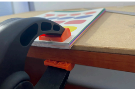
Fig. 46 - Processo de colagem da borda superior do bloco de materiais.
