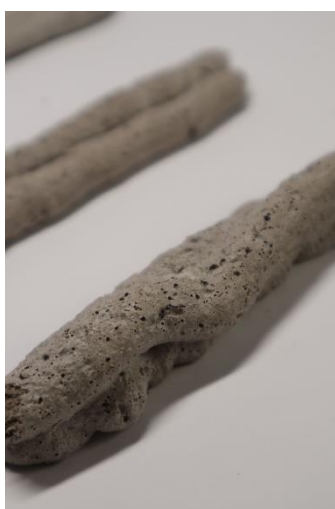
Figura 74. Observação de porosidade após período de secura, em amostra P.4.
