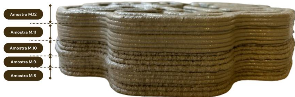
Figura 72. Impressão de amostras relativas ao segundo momento do procedimento experimental, onde se observam as características visuais das camadas referentes às amostras M.8, M.9, M.10, M.11 e M.12.
