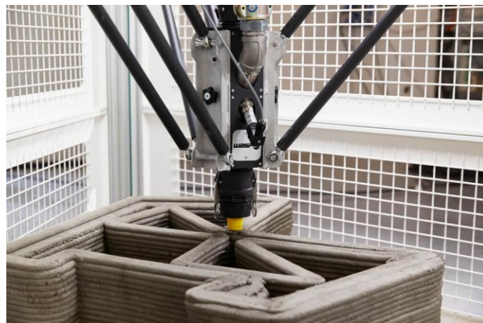
Figura 20. Ilustração do processo de impressão 3D LDM, com impressora Wasp (3D Bonum, 2020).
