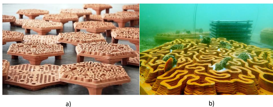
Figura 34. Recife artificial em argila. a) Método de disposição modular das estruturas; b) Implantação de fragmentos de coral na estrutura como objeto de monitorização (Eduardo Souza, 2020).
