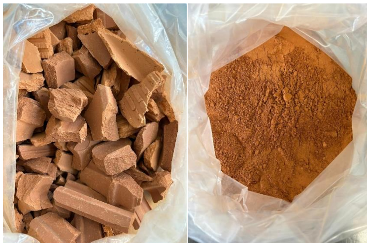
Figura 65. Antes e após o processo de trituração do tijolo, de forma a obter o material desejado para o procedimento experimental, o pó de tijolo.
