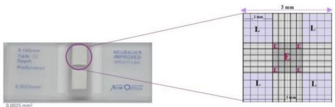
Figura 11- Câmara de Neubauer, representação esquemática: L - leucócitos; E- eritrócitos.(13)
