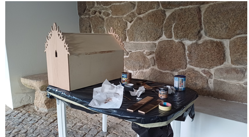
Testes para tingimento da madeira e posterior envernizamento.
