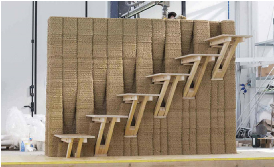
Figura 24 – Impressão 3D com uso de terra crua realizada pela WASP e IAAC (Chiusoli, 2018).
