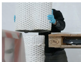
Figura 42 – Processo de empilhamento das seções impressas, Patrick Bedarf (Bedarf et al., 2023)
