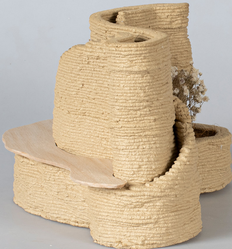
Figura 141 – Vista lateral do mobiliário urbano impresso em escala reduzida.
