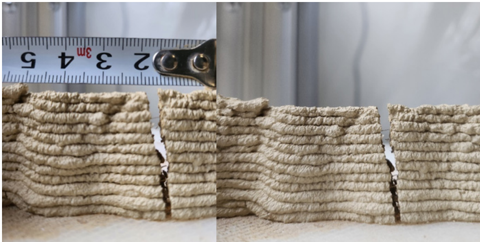
Figura 72 – Fissuras apresentadas na impressão da composição TAPMCARFO 6.5.
