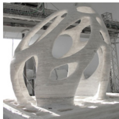
Figura 04 – Primeira obra arquitetônica impressa em 3D (Turner, 2009b).
