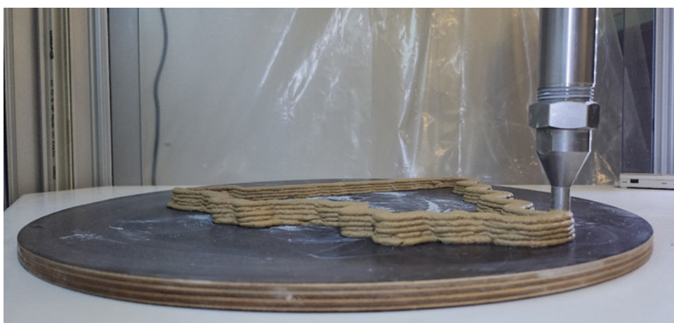
Figura 70 – Teste de impressão da composição TAPMCARF 5.1 na DELTA WASP 40100.
