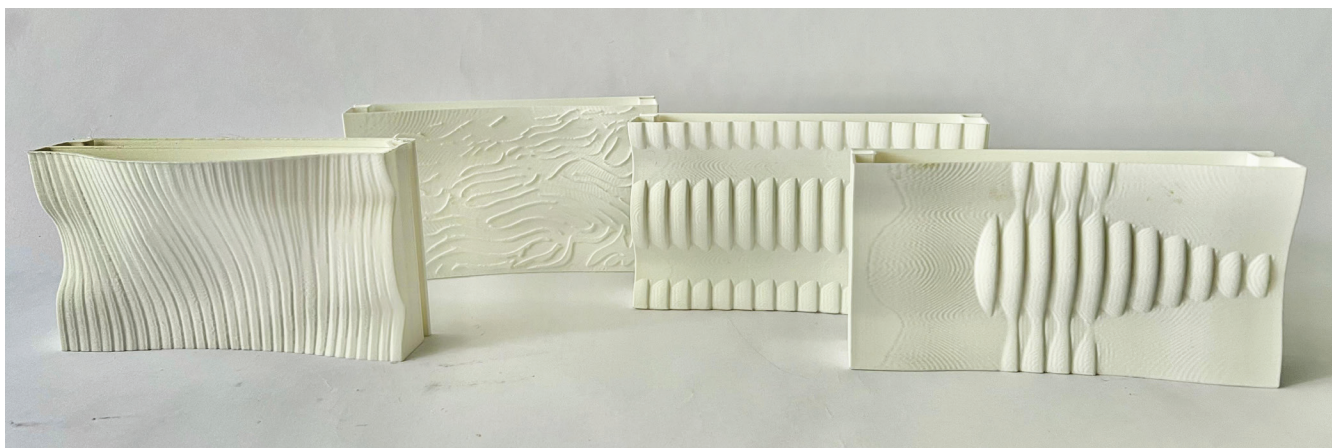
Figura 72: Testes de impressão em PLA Fonte: Autora
