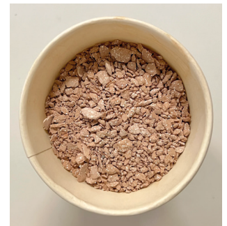
Figura 52: Amostra com reação de desintegração
