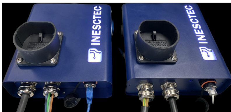
Figura 4.2: Unidade de carregamento EVSE utilizadas nos testes no SGEVL, INESC TEC (inescevse005 e 006)
