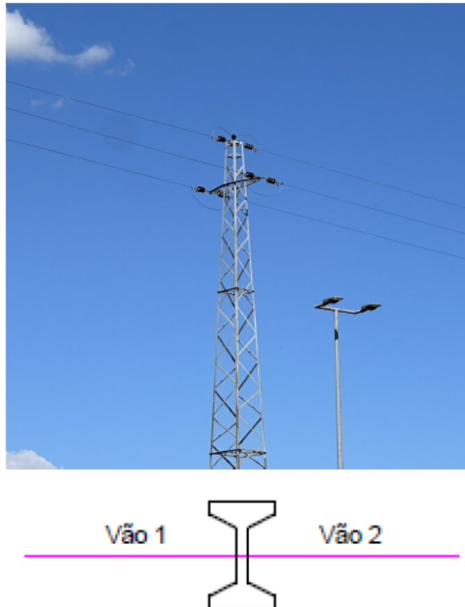
Figura 2.14: Apoio com função de alinhamento [23]
