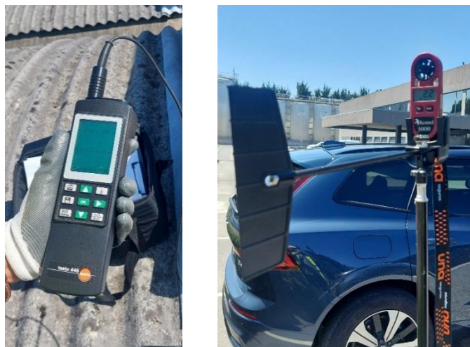
Figura 13- Instrumento de medição climática (esquerda) e anemómetro (direita)
