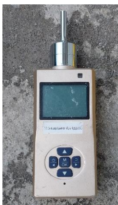
Figura 10- Analisadores de gases inorgânicos específicos (Ex: analisador de H 2 S)
