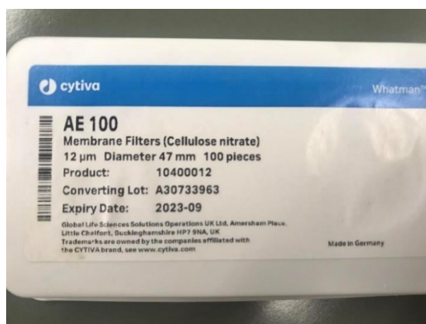
Figura 3-Exemplo de filtros usados de Whatman
