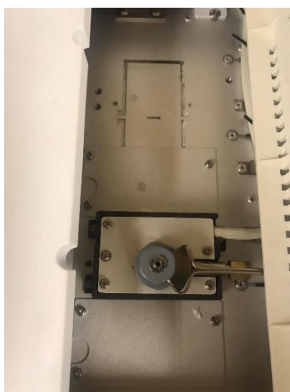
Figura 16-Injetor onde a seringa entra com o analito
