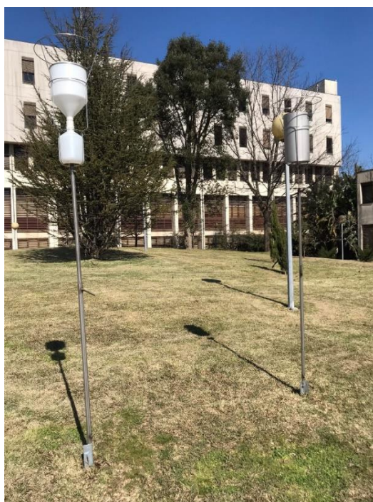
Figura 8-Amostradores afixados no jardim da FCUP para amostras por precipitação (esquerda) e amostras de microplásticos por deposição seca ou húmida (direita)
