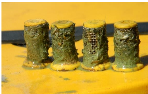
Figura 18. Filtros de pontas de pulverização com resíduos de agroquímicos (Fonte: Revista Cultivar, 2020).
