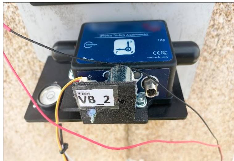
Figura 3.7: Acelerómetro instalado in loco Fonte: Arêde et al. (2024)
