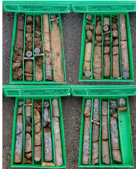
Figura 3.2 Exemplo do testemunho de uma sondagem (Campanha de Prospeção de 2023 realizada pela IP para o concurso do Lote A da Fase 1 da Linha de Alta Velocidade Porto-Lisboa).
