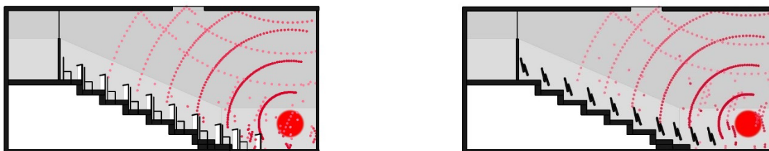
Figura 67 Vista em corte da simulação da propagação do som no espaço com alterações no tipo de cadeiras e bancadas.
