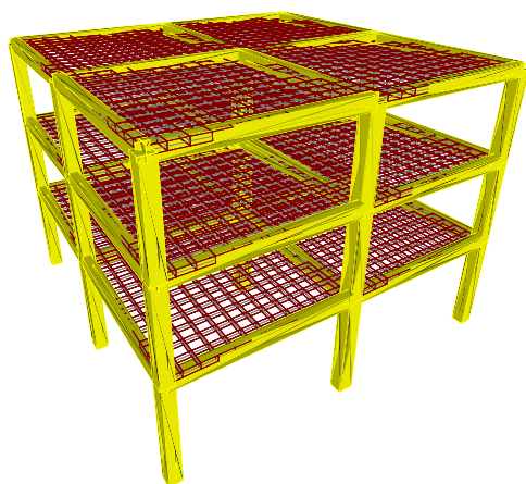
Figura 32 – Modelo 3D em SAP2000 da estrutura em estudo. (Carreira, P., 2021)
