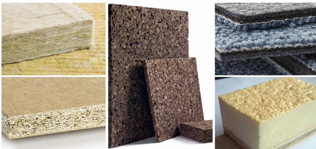
Figura 2.13 - Da esquerda para a direita apresentam-se como exemplos: fibras minerais (lã de rocha) [17], aglomerado negro de cortiça [18], alcatifa [19], aglomerado de fibras de madeira [20] e poliuretano expandido [21].
