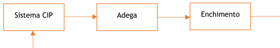
Figura 3.1 - Esquema simplificado do percurso da água e das soluções de limpeza na execução de um programa CIP.
