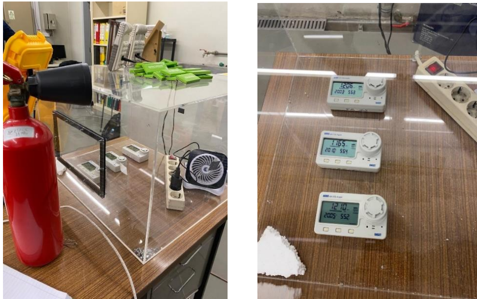
Figura 24 - Ensaio de aferição dos sensores para medição da concentração de CO 2 efetuado em laboratório.
