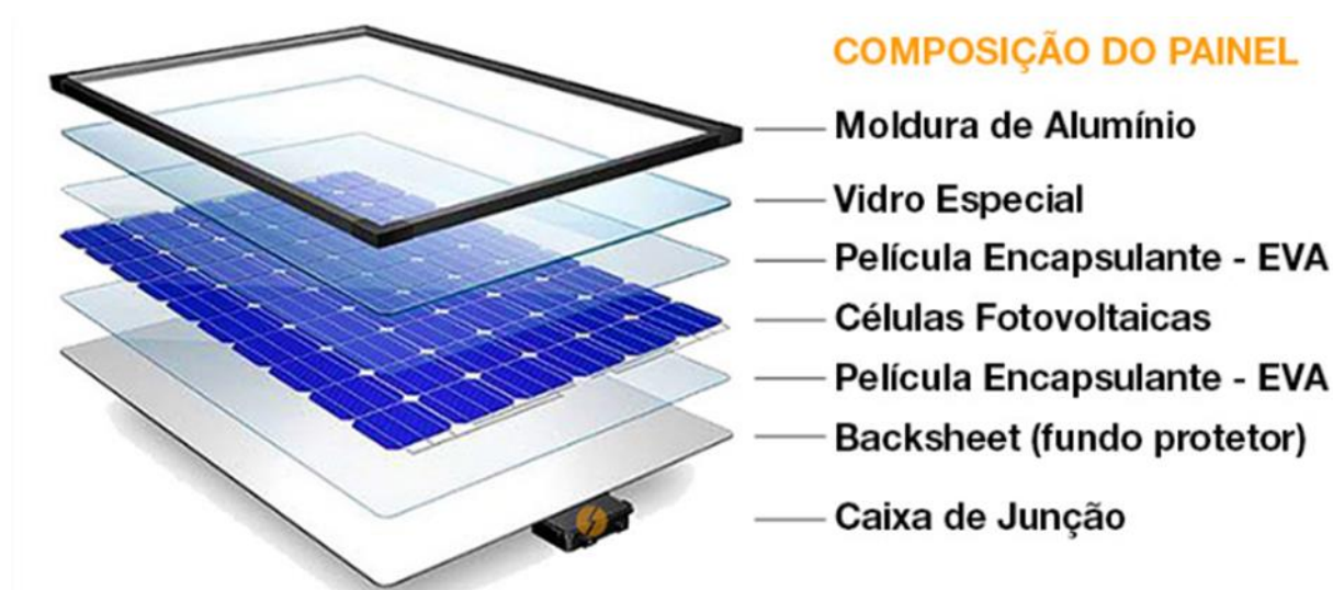
Figura 6 - Composição Painel Solar Fotovoltaico (Fonte: Ploter 2024)
