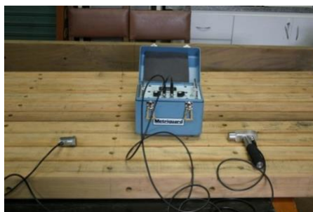
Legenda 2. 22 - Componentes do aparelho METRIGUARD.
