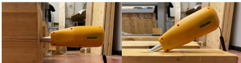
Legenda 2. 13 - Medição direta (esquerda); Medição indireta (direita).
