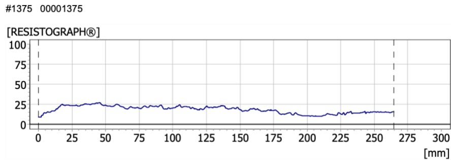
Legenda 4. 21 - Ensaio de Resistograph realizado à viga 2 (pisso 3, zona 1, lado esquerdo), anteriormente sem nenhuma patologia observada.
