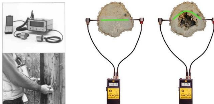
Legenda 2. 25 - Aparelho para deteção acústica de insetos xilófagos – FAKOPP TreeSonic Timer.
