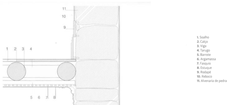
Legenda 3. 5 - Pormenor ligação de pavimento com fachada.
