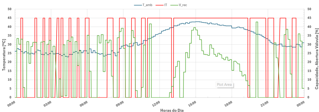
Figura 3.19: Variação da temperatura ambiente, capacidade dos compressores IT e da válvula flash gas no dia 22 de agosto.
