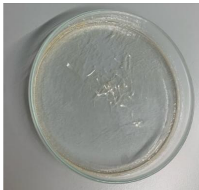
Figura 52. Película obtida a partir da dispersão do colagénio em água e glicerina.
