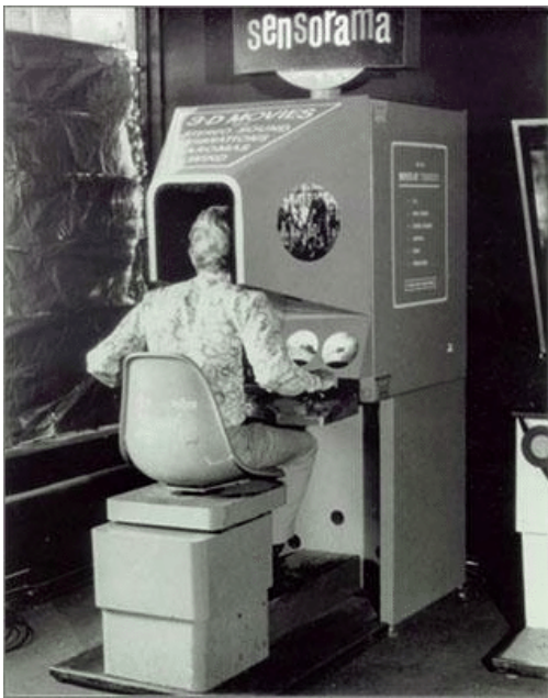
Fig 2.1D “Virtual Reality Machine, Sensorama, created by Morton Heilig in the 50s” (Figura 1. Máquina de Realidade Virtual, Sensorama, Criada Por Morton..., n.d.).
