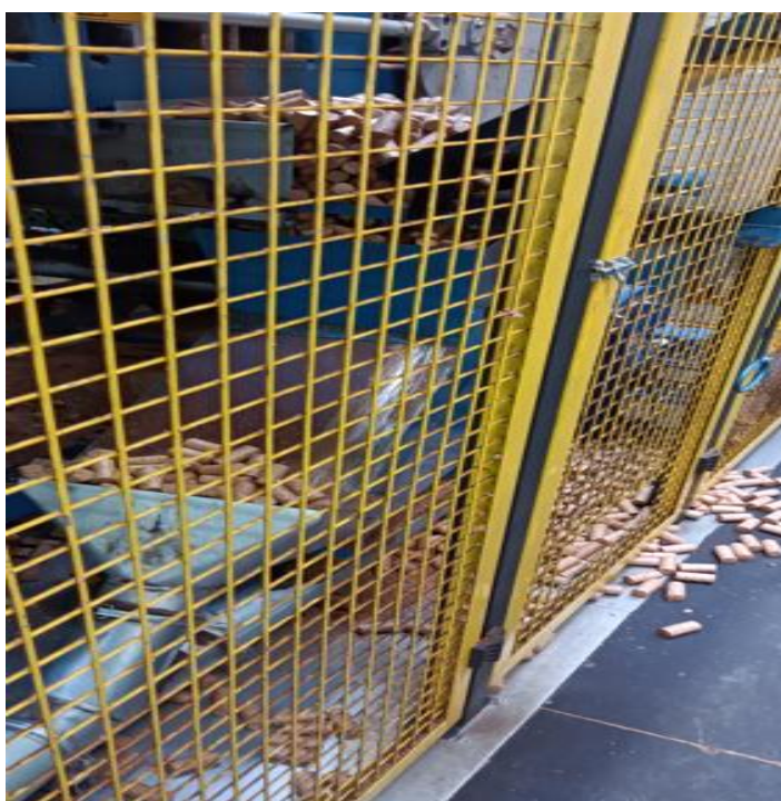
Figura 22 - Entupimento na Saída de Rolhas
