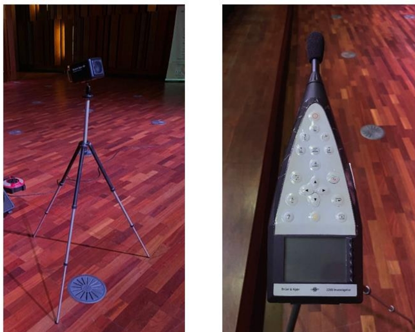
Fig. 4.9 - Fonte sonora Brüel & Kjær ( Echo Speech Source ), modelo 4720; Tripé portátil Brüel & Kjær, modelo UA0049 e Sonómetro Brüel & Kjær, modelo 2260 [fotos do autor]
