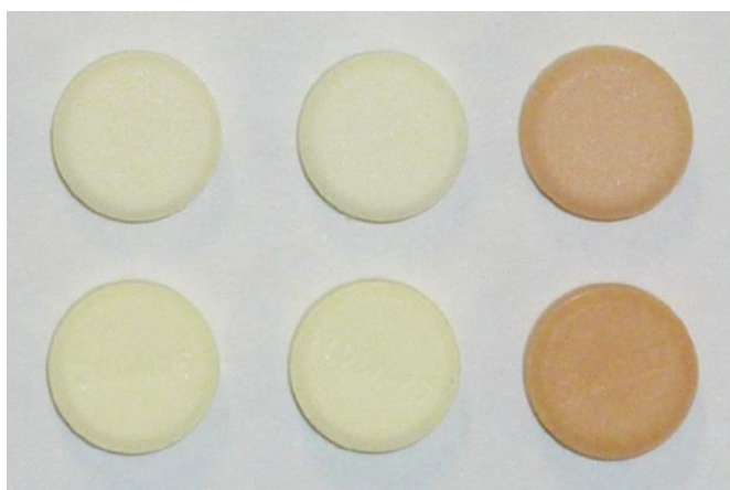
Figura 9 – Fotografias de comprimidos de clozapina [45] . Esquerda – controlo; centro - seis semanas em MCA; direita – exposto a condições ambientais.
