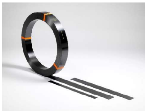
Fig. 11 – Exemplo de laminado de fibras de carbono [13]
