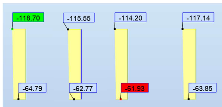
Fig. 40 – Diagramas de esforços axiais nos pilares apoiados na laje
