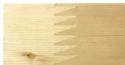
b) Ligações "fingerjoint" ou juntas dentadas
