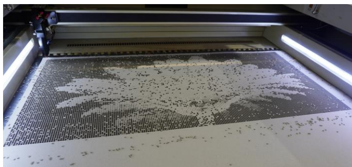
Fig. 130 Corte a laser de cartão prensado com base na imagem do crisântemo
