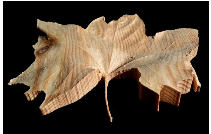
Fig. 83 Folha seca fresada em madeira
