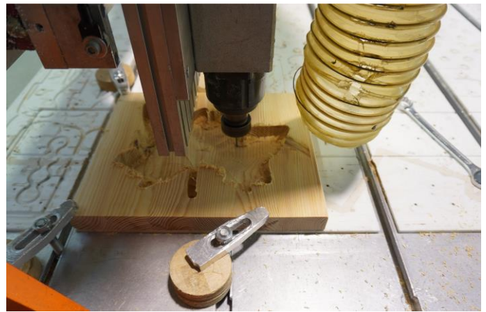
Fig. 82 Fresagem da folha seca no FabLab Lisboa
