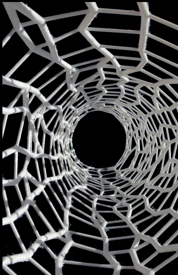
Fig. 115 Vista do interior da maquete do tronco de pinheiro impressa em PLA
