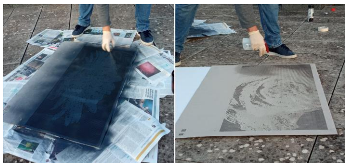
Fig. 131 Processo de produção dos painéis: à esquerda, tinta em spray a ser aplicada sobre acrílico; à direita, acetona a ser borrifada em esferovite
