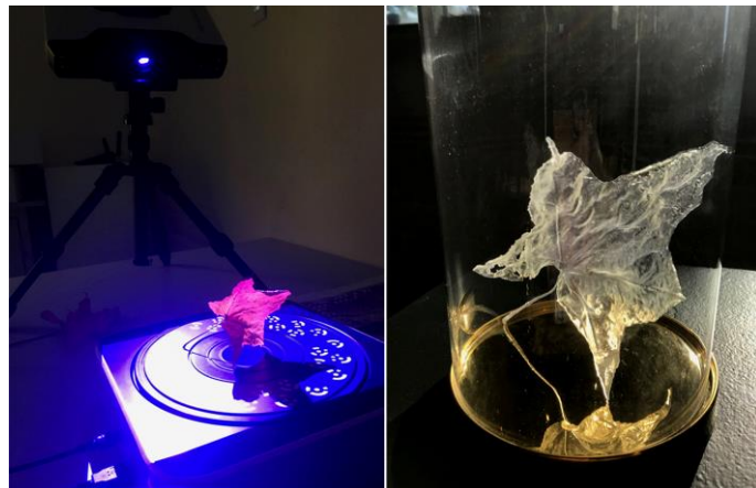
Fig. 55 Processo de digitalização a laser e modelo impresso em resina de uma folha seca para a escultura evolution , Yuko Oda, 2021 (Shining 3D, 2022)
