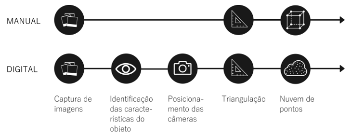
Fig. 57 Esquema do processo fotogramétrico manual e digital
