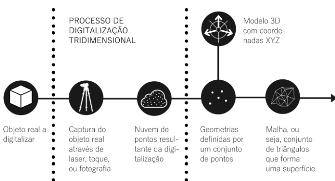
Fig. 51 Esquema do processo de transformação de um objeto real numa malha digital
