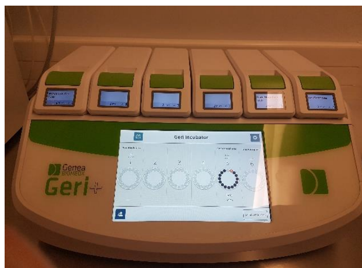
Figura 8 - Incubadora de cultura embrionária, que permite a monitorização de 6 conjuntos de embriões em simultâneo – normalmente correspondentes cada conjunto a um casal (imagem obtida no CEIE).
