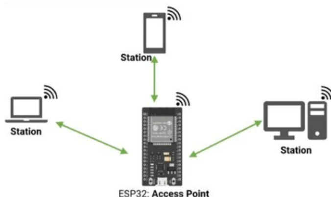
Figura 3.13 – ESP32: Modo Access Point [64]
