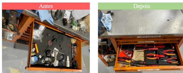
Figura 4.1: Carrinho de ferramentas antes e depois da aplicação da metodologia 5S.
