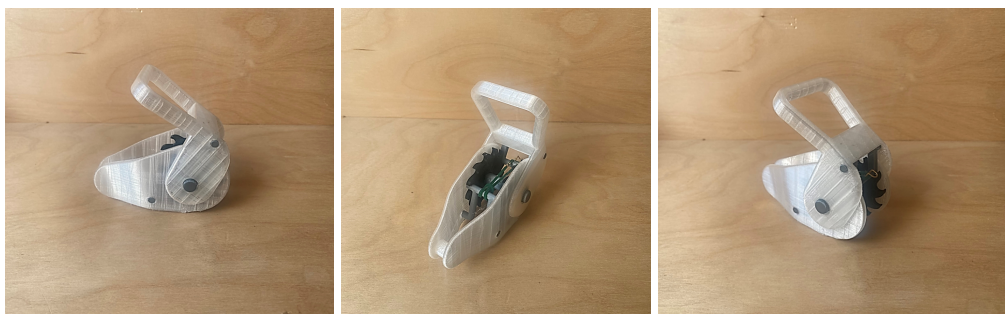
Fig.70. Maquete do sistema de roquete, obtida através de fabricação por impressão 3D.
