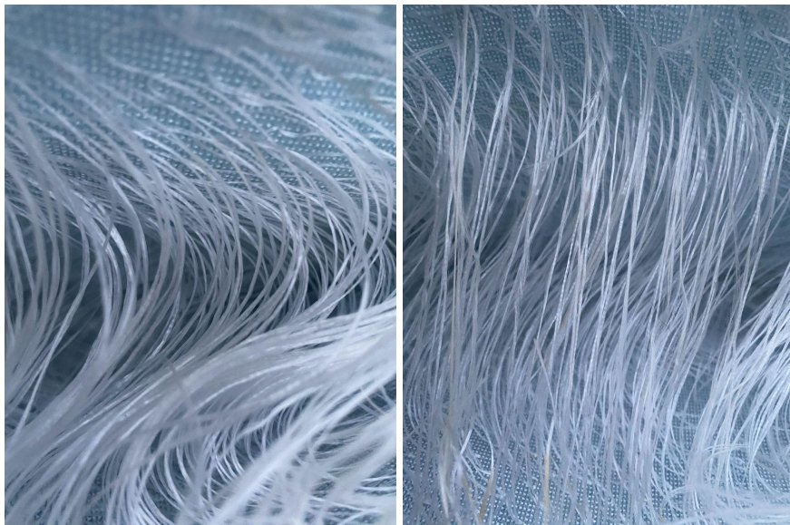
Fig.57. Estrutura Dropstich (imagem da esquerda- Simulação da estrutura sem ar, imagem da direita- Simulação da estrutura com ar)- Fotografia do Autor
