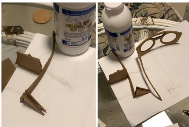
Figura 59 Curvatura da haste feita com gabarito de papel e molde improvisado. Foto: Autor
