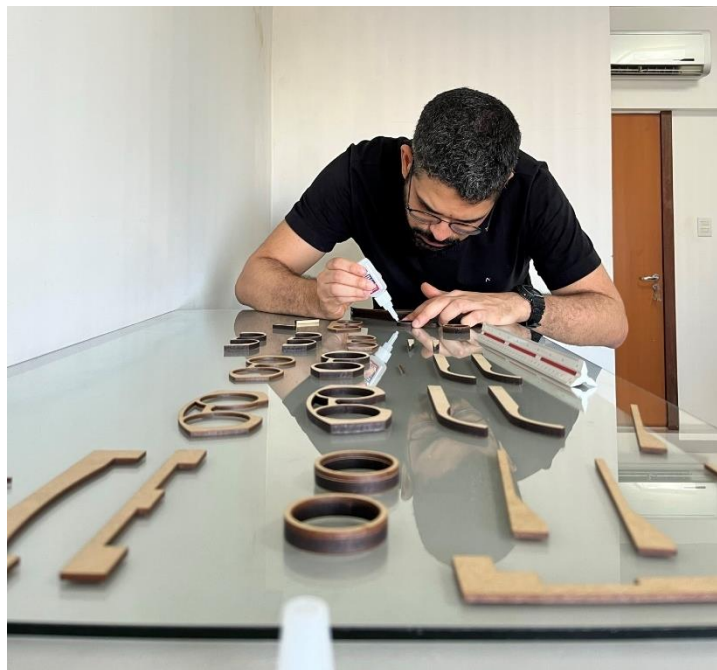
Figura 78 Montagem manual das peças cortadas em CNC Laser. Foto: Autor
