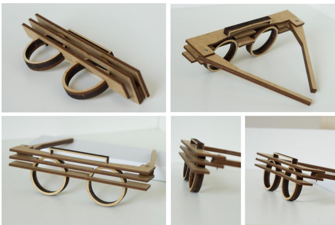
Figura 72 Protótipo modelo "Ripa" em MDF cortado em CNC Laser. Foto: Autor
