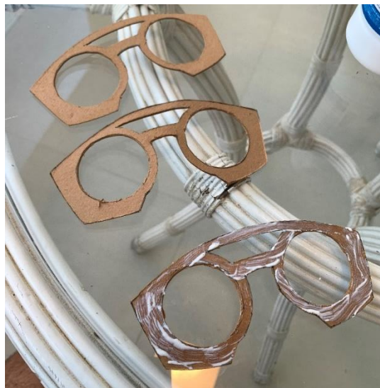
Figura 56 Camadas da frente dos óculos recortadas para sobreposição. Foto: Autor
