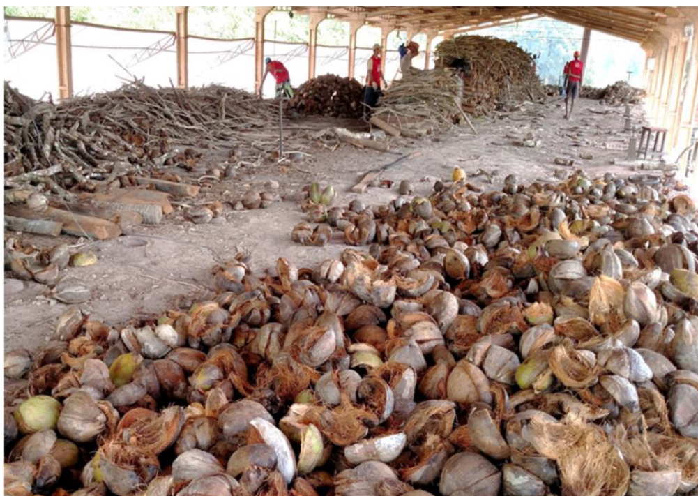
Figura 15 Cascas de Coco Verde sendo utilizadas por indústria cerâmica como combustível sólido em fornos. Maragogi, AL (fonte: Marafon et al. (2019))
