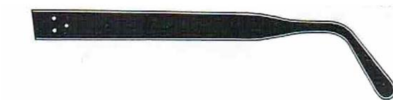
Figura 38 Haste pescoço de cisne. Fonte: Retirado de Sasieni (1975)
