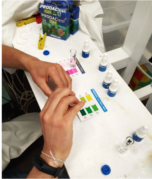
Figura 5 – Realização de testes para avaliação dos parâmetros físico-químicos da água.
