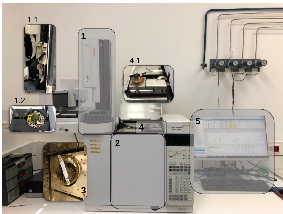
Figura 3-iv – Fotografia de um cromatógrafo em fase gasosa, com identificação dos componentes: 1 – injetor, 2 – forno, 3 – coluna cromatográfica, 4 – detector e 5 – software.
