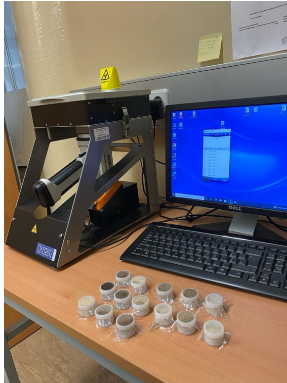
Anexo 12 – O equipamento X-MET7000 SERIES HANDHELD XRF ANALYSER e as amostras utilizadas para leitura.
