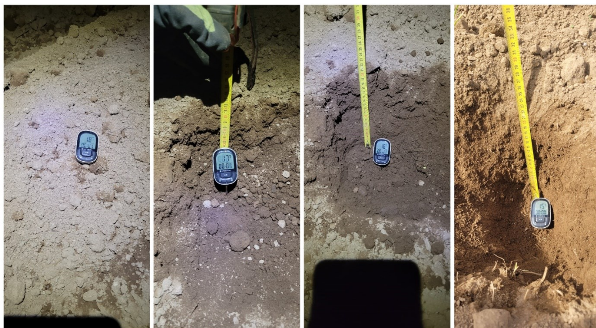
Figura 5 – Medição da temperatura do solo a diferentes profundidades. 10, 20, 30 e 40 cm.
