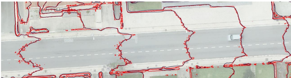
Figura 82: Criação de curvas de nível, exemplo 1 e 2 sobrepostos sobre a estrada
