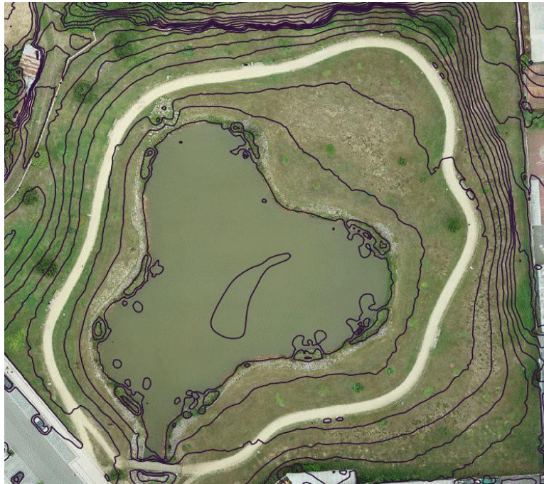
Figura 80: Criação de curvas de nível, sobre pequena elevação
