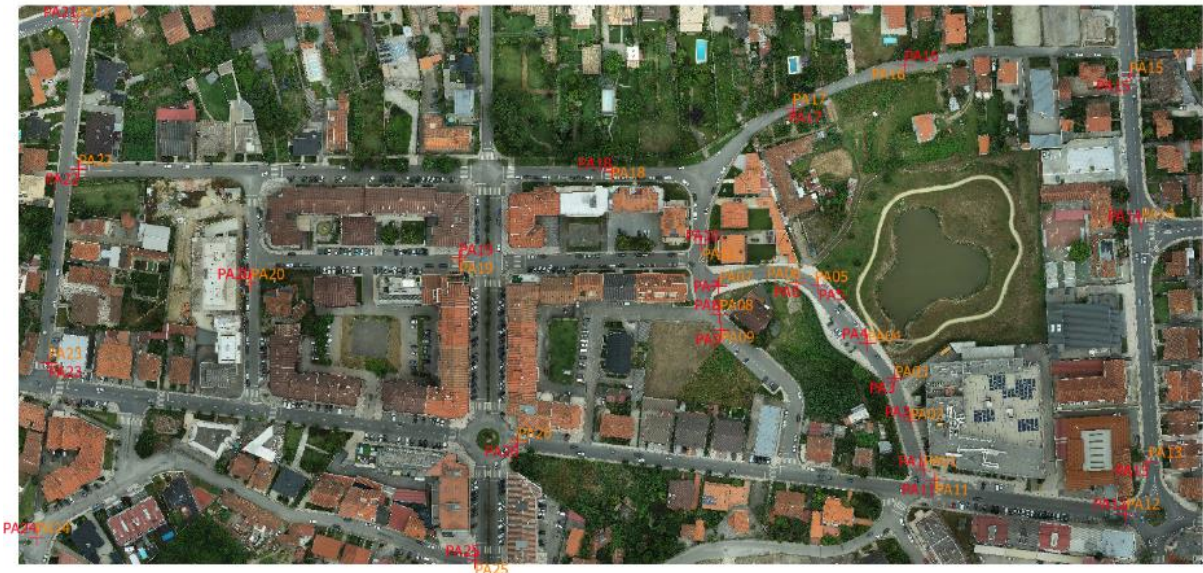
Figura 76: Criação da Shapefile dos pontos de apoio com as coordenadas (X, Y) da ortofoto (processada com todas as fotos) e cotas (Z) do DSM (processado com todas as fotos)
