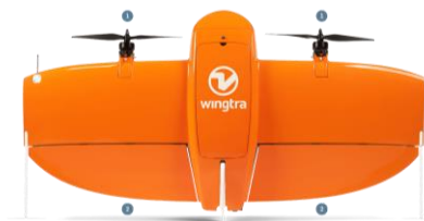
Figura 16: WingtraOne Gen II com decolagem e aterragem vertical (VTOL)
