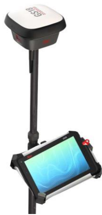
Figura 26: Rover Leica GS18T GNSS RTK, o respetivo bastão e o Tablet Leica CS30
