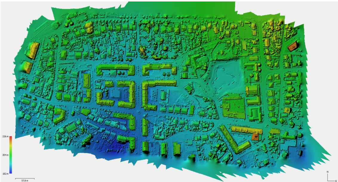
Figura 54: Representação do modelo digital de superfície (DSM), processado com todas as fotos
