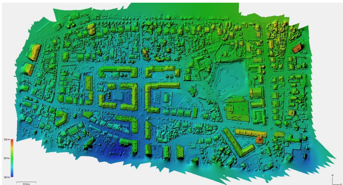
Figura 61: Representação do modelo digital de superfície (DSM), processado sem as fotos oblíquas
