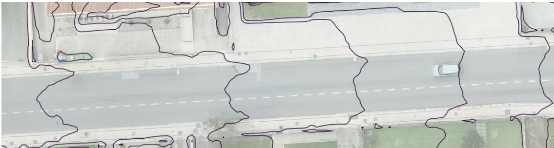
Figura 81: Criação de curvas de nível, exemplo 2 sobreposto sobre a estrada
