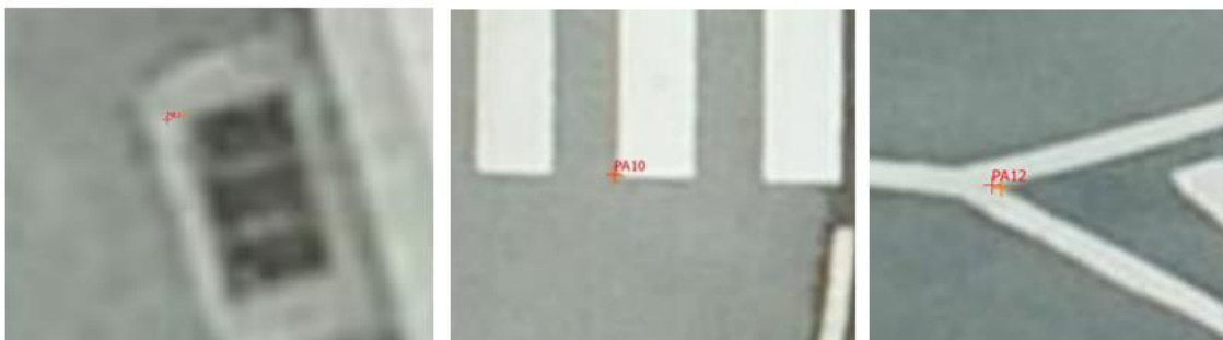
Figura 75: Exemplos de pontos de verificação obtidos através do levantamento topográfico (a vermelho) e através da ortofoto (a laranja)
